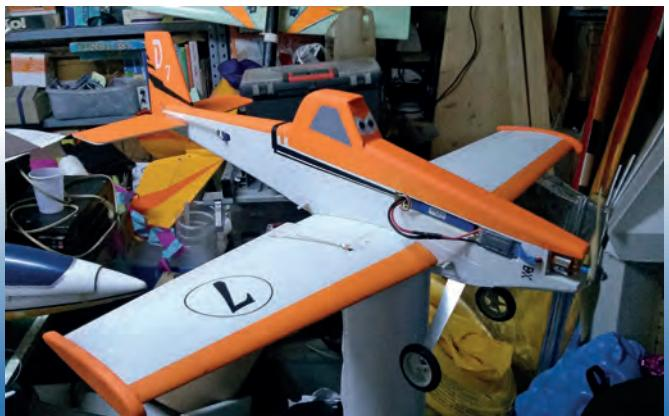
*Il Dusty ha una struttura mista balsa/Depron/Styrodur. Le cerniere sono in tessuto sintetico che, nel caso dell'autore, è stato ricavato da un vecchio ombrello. Un modello molto economico e veloce da costruire in serie per divertirsi con gli amici.*
