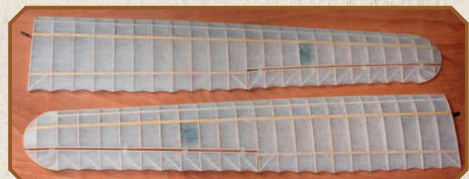
Il modello è rivestito in Litespan che si applica come la carta Modelspan, ma è poliestere, si tende con ferro da stiro e si rifinisce con tre mani di tendicarta. I bordi d'uscita in Kevlar si rivestono lasciando un margine di 5 mm al rivestimento che va risvoltato su se stesso dopo averlo intagliato a V sui vertici delle centine.
