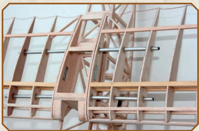
Particolare degli alettoni finiti e del bordo d'uscita in Kevlar come sullo stabilizzatore. Le ali vengono mantenute unite con dei magneti incastriati nel balsa e a contatto col compensato da 0,4 che col suo spessore contribuisce a ridurne in po' la potenza davvero notevole.
