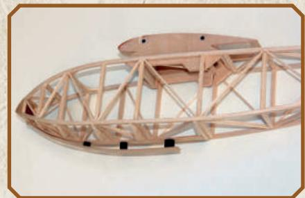
La cabina dell'ala è in balsa da 3 mm rivestita in compensato da 0,4 e viene incollata alla fusoliera. La baionette sono tondini di fibra di vetro da 4 mm. Sono un po' più pesanti del carbonio, ma meno fragili. Il pattino è formato da due strisce di compensato da 1 laminate con epoxy su di una sagoma che permette di mantenerle in forma. Gli ammortizzatori sono delle rondellone di spugna incollate con colla a contatto, mentre il pattino posteriore è un semplice archetto in midollino o bambù.
