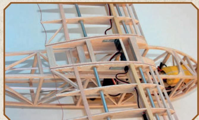
I servi degli alettoni sono incollati col biadesivo a delle piastrine di compensato bloccate con quattro viti per consentire un facile smontaggio in caso di bisogno. Le squadrette degli alettoni sono in compensato da 1,5 e i tiranti in acciaio da 1 mm. Non ho previsto la possibilità di regolare meccanicamente gli alettoni e mi sono affidato soltanto ad un allineamento preciso. Nella foto a destra, le semiali montate con i cablaggi completi.
